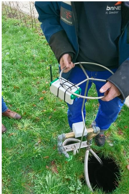
*Daten aus Schächten könnten mit Hilfe einer neuen Technologie effizient übermittelt werden - hier in Zusammenarbeit mit badenova (bnnetze)*
